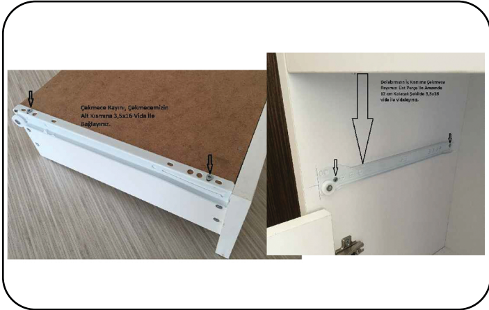
İŞLEM 5: Çekmecelerimizin raylarını önce çekmece gövdesine daha sonra ünitemizin gövdesine 3,5x18 vida ile bağlayınız.
